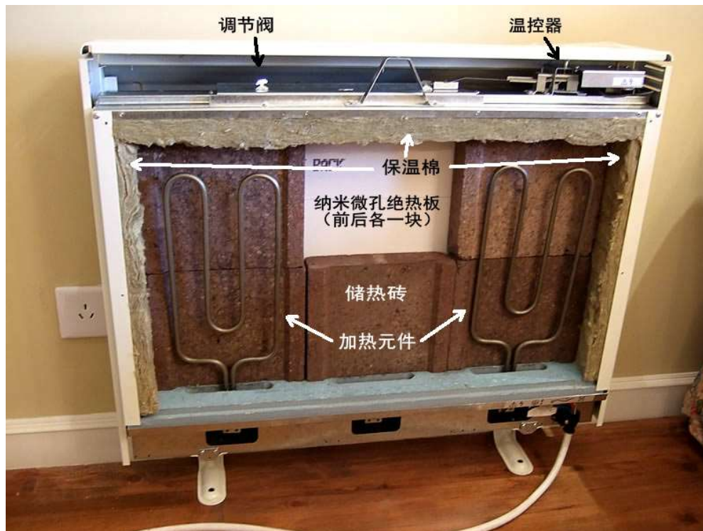
图 3 储热式电暖器内部结构
